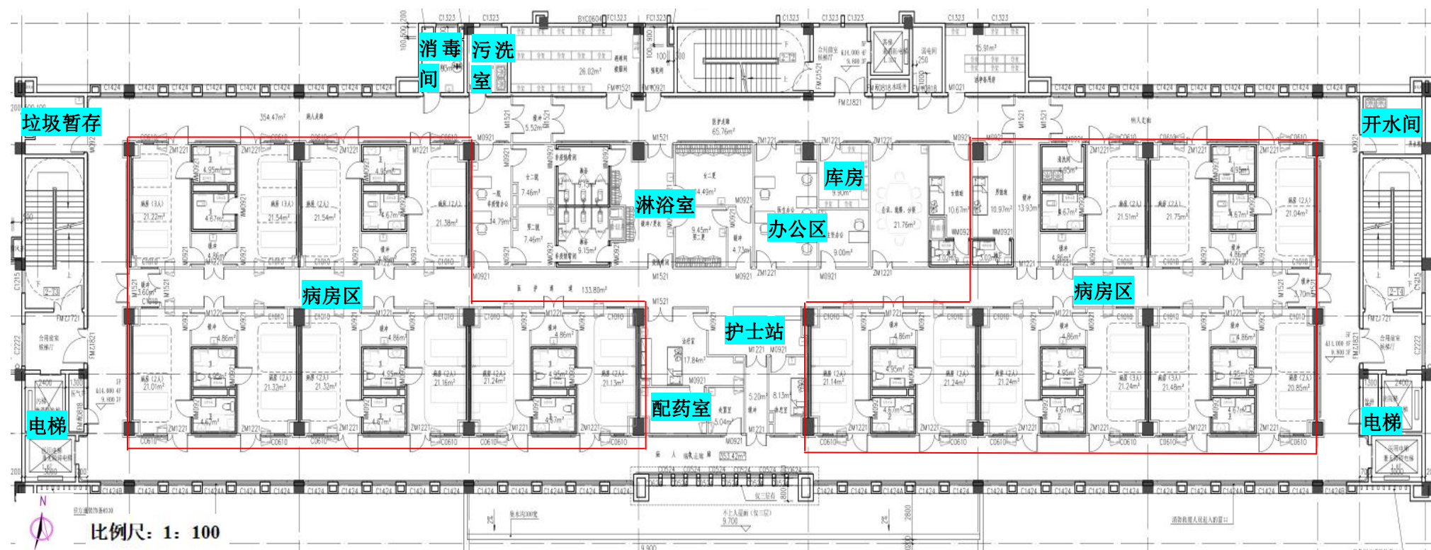
④项目门诊住院楼3~7层平面图
